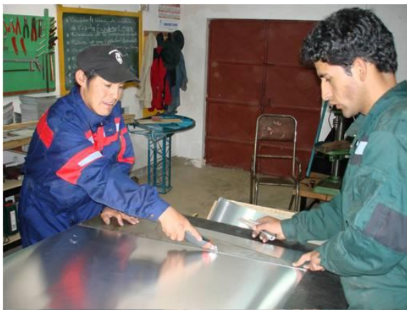
Imagen 2 muestra el corte de láminas de aluminio de alto brillo en un taller en Bolivia para la producción de cocinas parabólicas solares del método de construcción SK. Proyecto SOLIN de J. A. Garrido Vázquez, Madrid
