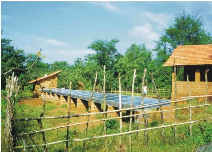
Imagen 1 muestra un secador de túnel para secar alimentos con energía solar, desarrollado en el proyecto de secado solar germano-indio con la Universidad Técnica de Munich
