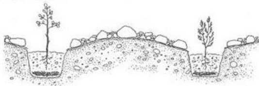
Abb. 15-b (unten).—Mit Plastik unter den Steinen an der Oberfläche kann auch bei kargen Regenfällen den Pflanzen zusätzliche Feuchtigkeit zugeführt werden; bei Starkregen allerdings könnte „Überschwemmungsgefahr“ bestehen ...
