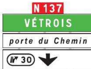
Da31a + E42 - exemple pour une sortie sur une rocade dont les échanges sont dénommés
