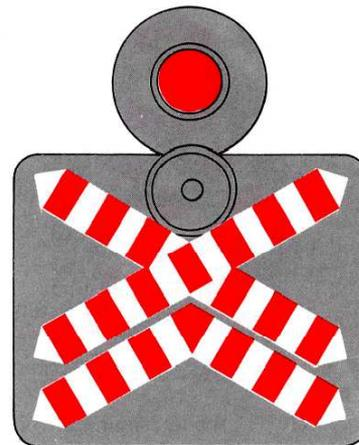
**G1a bis** — Passage à niveau à plusieurs voies muni d'une signalisation automatique lumineuse (art. 34-2)
