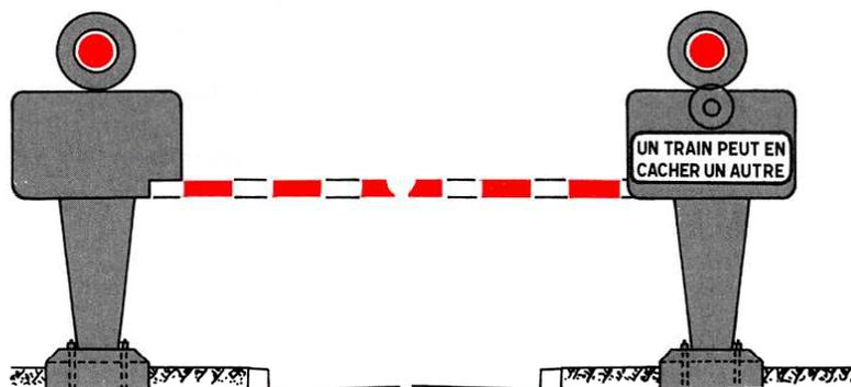
G2 — Passage à niveau muni d'une signalisation automatique,
